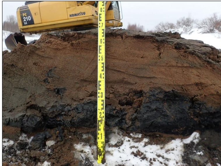
Pohjanäyte pohjoisemman saaren itäpuolelta. 40 cm:n vahvuisen hiekkakerroksen alla on pehmeää hiesua.
